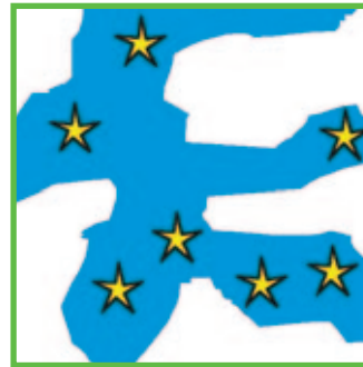
Wassergefüllte Pore mit gelösten Salzen
