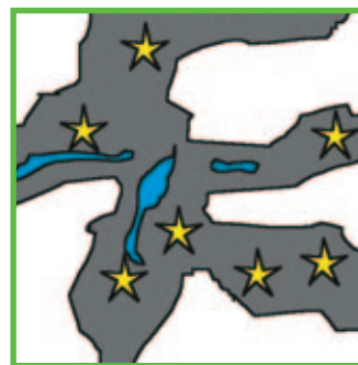
Mit KÖSTER Polysil TG 500 behandelte Pore – die Salze sind vollständig gebunden
